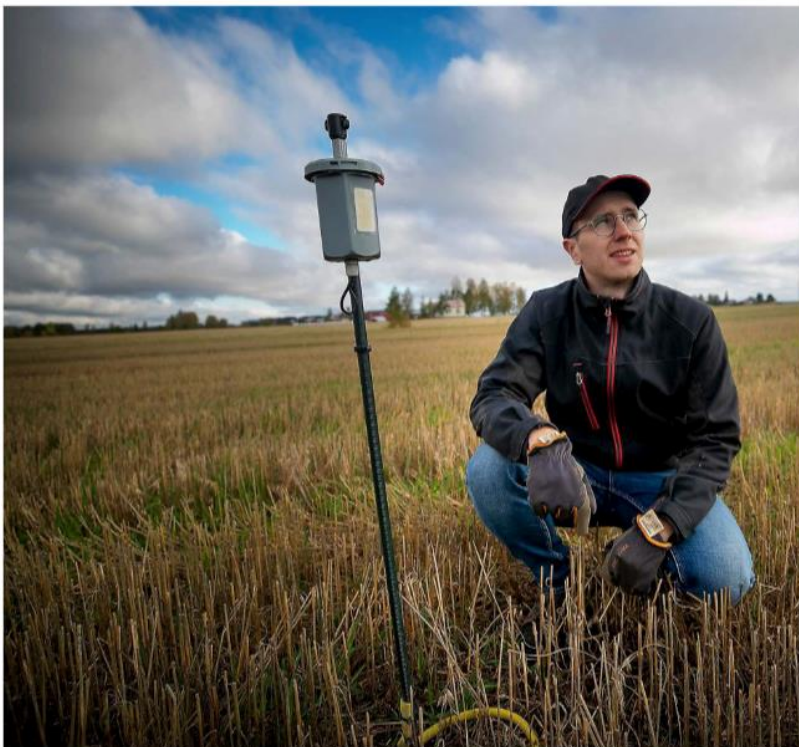
Mittarit kerryttävät jaakko Kankaan pelon olosuhteista reaaliaikasta dataa tutkijoiden käyttöön. Antennit lähettävät tiedot verkkoon Simpsonin maston kautta. KUVA: JAAKKO LEINUS
